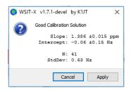
Für eine schnelle visuelle Überprüfung der resultierenden Kalibrierung bleiben Sie im **FreqCal**-Modus bei deaktivierter Option **Measure**. *WSJT-X* zeigt die angepassten Ergebnisse direkt auf dem Wasserfall und den angezeigten Datensätzen an.
