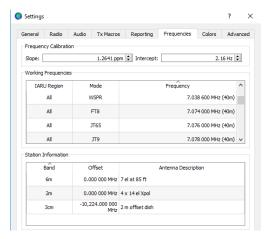
Working Frequencies: Standardmäßig enthält die Tabelle Working Frequencies eine Liste der üblichen Frequenzen für die Betriebsarten FT8, FT4, JT4, JT9, JT65, MSK144, WSPR und Echo. Gepflogenheiten können sich mit der Zeit oder durch Benutzer ändern, daher kann diese Tabelle geändert werden.
