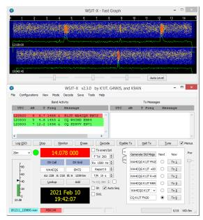
Im Gegensatz zu anderen *WSJT-X*-Modi arbeitet der MSK144-Dekoder während der Empfangssequenz in Echtzeit. Dekodierte Nachrichten erscheinen fast so schnell auf dem Bildschirm wie Sie diese hören.
