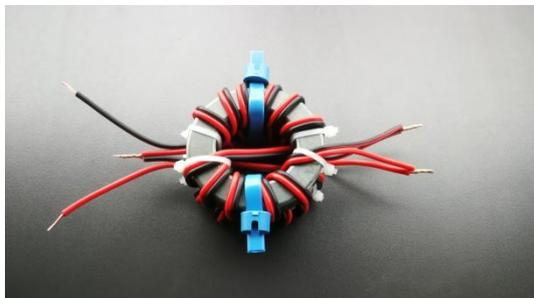
Wiederhole nun alle obigen Schritte, um einen zweiten 1:1 Strom-BalUn zu fertigen. Binde nun die beiden Kerne zusammen - wieder habe ich ein paar Kabelbinder verwendet. Stelle sicher, dass die beiden Kerne ausgerichtet sind - d. h. die Kabel treten an ungefähr denselben Positionen aus. An einem Ende der Baugruppe verbindest du die Drähte parallel: Rot mit Rot und Schwarz mit Schwarz. Dies sind die Enden,
