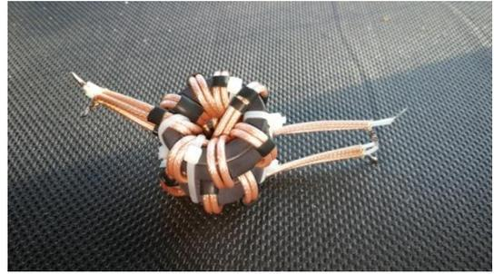
Aus dem Baumarkt besorgt man sich KFZ-Kabel aus  $2 \times 0.75 \text{ mm}^2$  Cu und schneidet zwei 820 mm lange Enden zurecht. Wickel jetzt 12 Windungen dieses Zwillingskabels auf einen FT240-61 Ringkern, um einen 1:1 Strom-BalUn zu bekommen. Die "Crossover" Wicklung ist keine elektrische Anforderung - es ist nur eine einfache Möglichkeit, die Kabelenden auf entgegengesetzten Seiten des Ringkerns hervortreten zu lassen. Verwende ein paar Kabelbinder, um die Kabelenden am Kern zu fixieren.
