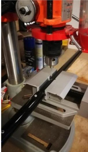
Entsprechend der Maßskizze werden jetzt die einzelnen GFK-Rohre A und B 170 mm und die Rohre B und C 140 mm ineinander geschoben. Ich markiere diesen Abstand vorher mit einem Stück farbigem Isolierband. Nach dem Vorbohren an den angegebenen Punkten sichere ich mit 3.5 mm Treibschrauben. Wenn alle Abstände eingehalten wurden, müßte also ein GFK-Träger genau 1.64 m lang sein.
