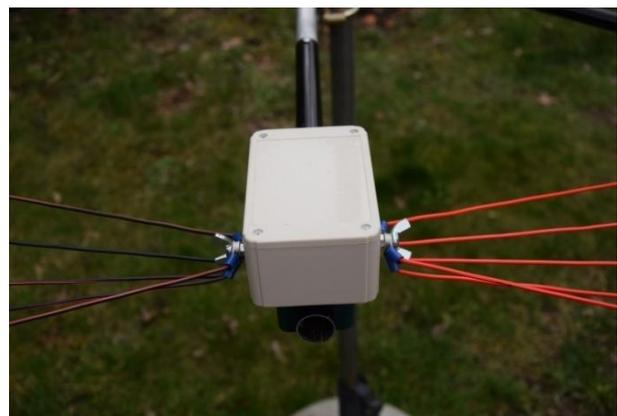
Danach schneide ich die Dipole entsprechend der Maße in der Tabelle zu. Als Material für die Strahler benutze ich Kabel aus der Kfz-Elektrik mit einem Querschnitt von  $2 \times 0,75 \text{ mm}^2$ . An das eine Ende eines jeden Dipols werden nun 5 mm Kabelösen angelötet. Die Ösen werden mit den Schrauben an der Anschlussbox verschraubt.
