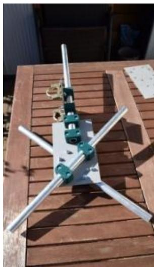
Auf der Grundplatte verschraube ich zuerst lose die sechs Rohrschellen für die drei 500mm langen Trägerrohre aus Aluminium. Damit die Trägerrohre für die Elementhalter über Kreuz befestigt werden können, werden jeweils ein Rohr oberhalb und ein Rohr unterhalb der Grundplatte mit den Rohrschellen verschraubt.
