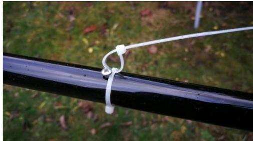
Das Befestigen der Dipolhälften mittels Kabelbindern ist nur eine Möglichkeit, diese an den Elementeträgern zu fixieren. Man könnte sie auch durchbohren und die Dipoldrähte hindurchführen.
