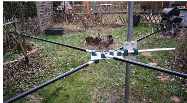
Nun geht es an den Aufbau des 1:4 Guanella-BalUn, den ich in einer separaten Datei beschrieben habe. Wenn der Balun fertig und in die Anschlussbox eingebaut wurde, kann diese am Ende des Trägerrohrs befestigt werden.
