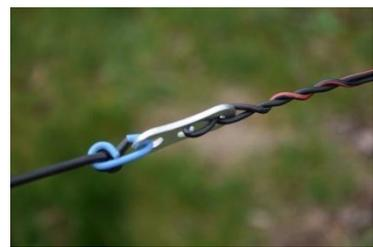
ich biege sie aus Resten von isoliertem Draht alter Netzleitung. Der Haken wird in den zweiten Seilspanner eingehakt. Die Dipolhälften werden jetzt durch kürzen der Gummikordel mäßig gespannt. Der Einsatz von metallischen Bauteilen an dieser Stelle wirkt sich nicht negativ auf das SWR aus.
