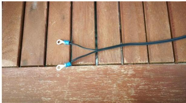
Dazu wird das zweiadrige Kabel einfach auseinandergezogen, so erhalte ich zwei exakt gleich lange Dipolhälften. Wer handwerklich geübt ist, kann auch die fünf Dipolhälften zusammen löten und mit einer 6 mm Kabelöse versehen. Die Schrauben in der Anschlussbox sind dann anzupassen.
