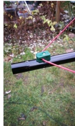
Eine optisch sehr schöne Variante entdeckte Micha, DL7VTE. Er verwendet Klemmen, wie sie zum Befestigen von Spanndraht an Zaunpfosten benutzt werden – ich bevorzuge diese Variante ebenfalls.
