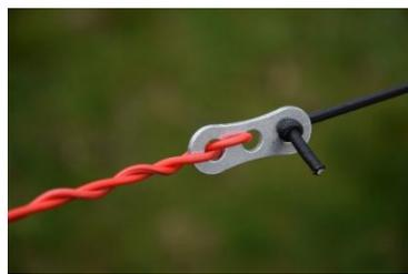
Auf der gegenüberliegenden Seite angelangt, werden an jeder Dipolhälfte die Seilspanner angebracht, von denen jeweils einer ein etwa 30 cm langes Stück Gummikordel bekommt. An deren Ende befestige ich einen Haken,
